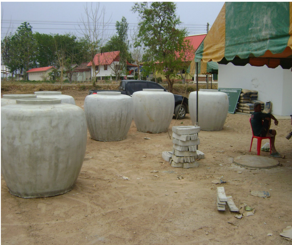
ผสมปูนฉาบกับน้ำ สาดให้ทั่วภายในโอ่ง ทิ้งไว้ระยะเวลา ๒-๓ วัน แล้วค่อยเติมน้ำให้เต็ม
