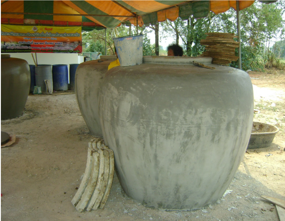
แกะแบบปูนและแบบไม้ในโอ่งออกให้เรียบร้อย
